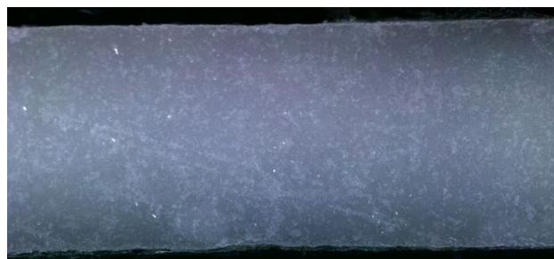
Abbildung 41: Schliffbild einer VPP- Al 2 O 3 ohne PBF-Bearbeitung; hier sind keine vertikalen Mikrorisse detektiert.
