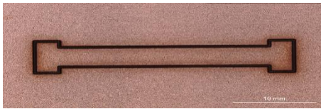
Abbildung 30: Ausgelaserte Struktur auf der DCB (li.) zur Leitfähigkeitsmessung und TST.
