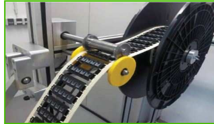
Rolle zu Rolle Fertigung des 2E MID Strömungssensors
